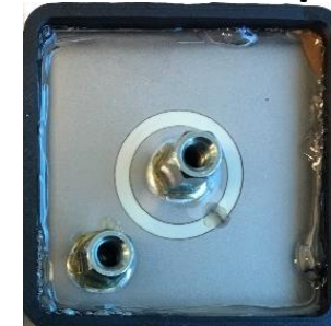
DBC test coupon
